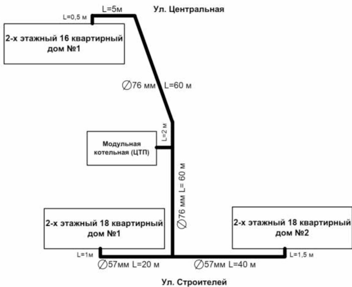
Рисунок 1.3.2.2 - Схема тепловых сетей централизованной котельной Жилого фонда п. Прогресс
